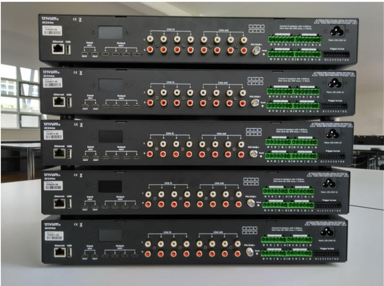
Wählen Sie aus, welches Gerät Master sein soll, in diesem Beispiel das oberste. Alle anderen Geräte in den Slave-Modus versetzen:
