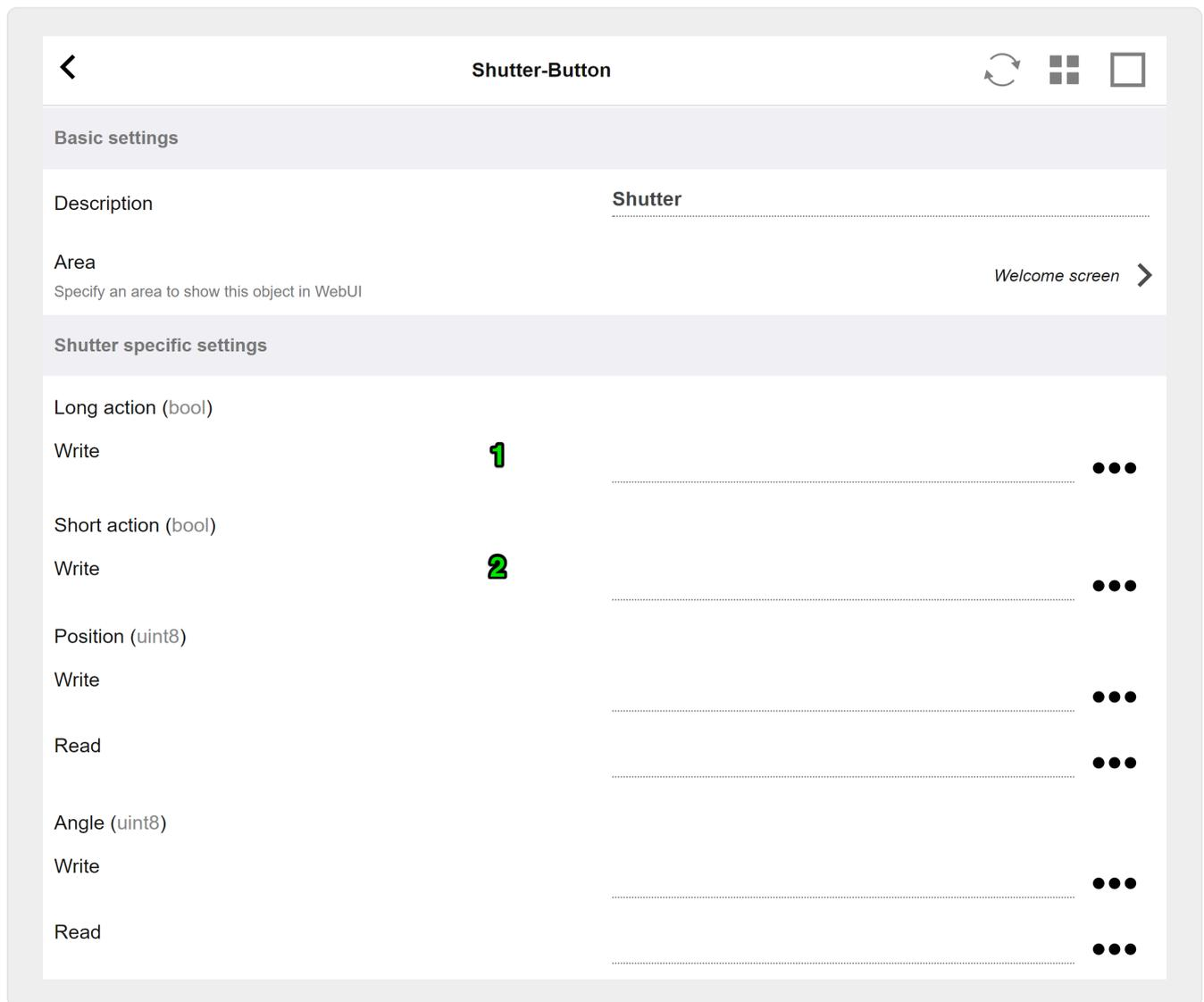
Le plus important avec un actionneur de volet KNX est l'action longue (1) pour l'actionner complètement vers le haut ou vers le bas, et les actions courtes (2) pour changer l'angle des lamelles. L'écriture directe de la position et de l'angle sous forme de valeur 8 bits peut être prise en charge uniquement par certains actionneurs KNX.
