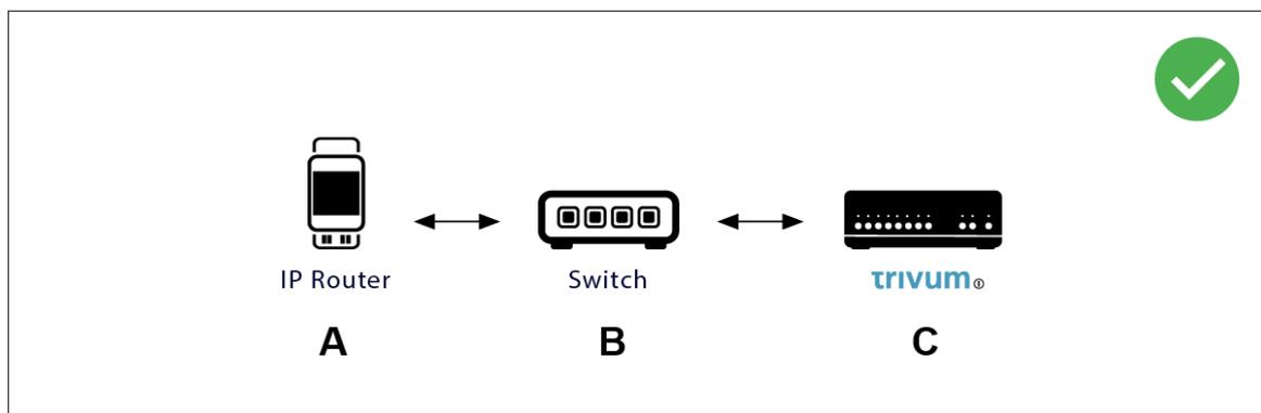
La multidiffusion signifie essentiellement : l'appareil (A) (routeur IP) envoie un message KNX "1/2/3 1bit 1" au commutateur réseau (B) et indique à ce commutateur de l'envoyer à tous les autres appareils du réseau.
