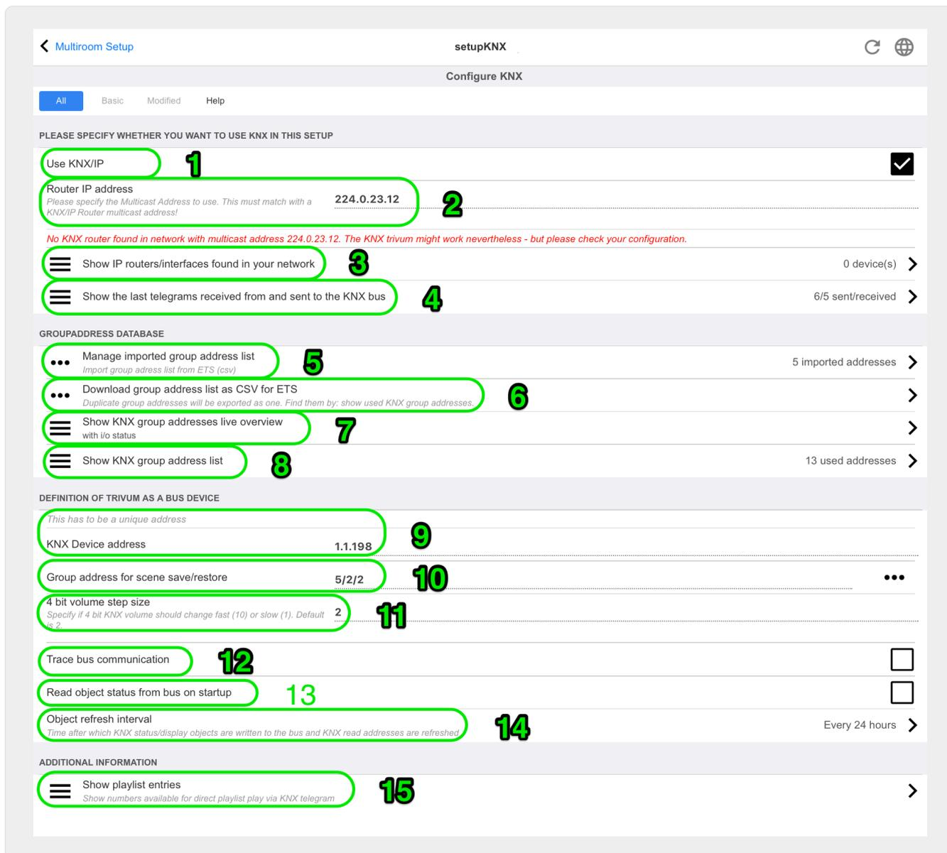
1 - active la réception et le traitement des événements KNX du réseau, ainsi que l'envoi de l'état KNX au réseau, si configuré.
