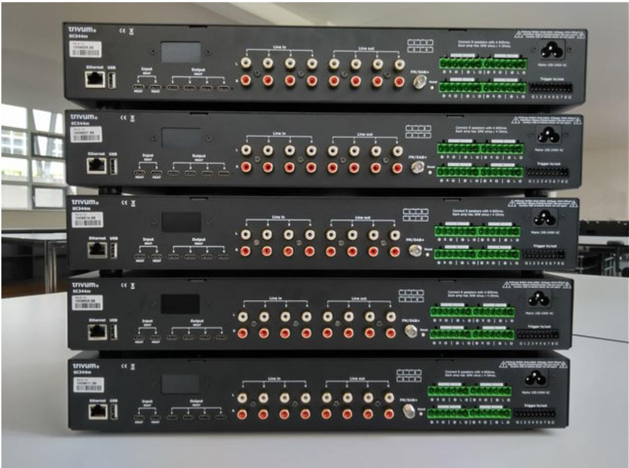
Sélectionnez l'appareil qui doit être le maître, dans cet exemple le plus élevé. Passez tous les autres appareils en mode esclave :
